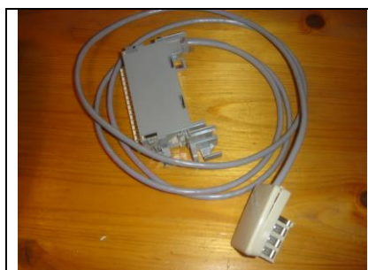
Le module RCPT porte les 4 RJ45 du splitter.
